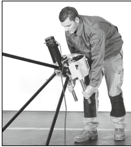
Fig. 2: Aufstellen der Maschine Fig. 2: Putting up the machine Fig. 2: Pose de la machine Fig. 2: Raddrizzamento della macchina Fig. 2: Instalación de la máquina Fig. 2: Plaatsen van de machine Fig. 2: Uppställning av maskinen Fig. 2: Oppstilling av maskinen Fig. 2: Opstilling af maskinen Fig. 2: Opstilling af maskinen Kuva 2: Koneen pystytys Fig. 2: Instalação da máquina Rys. 2: Ustawianie maszyny Obr. 2: Stroj postaviti Obr. 2: Stroj postaviti 2. ábra: Felállítani a gépet Sl. 2: Postavljanje stroja Slika 2: Postavitev stroja Fig. 2: Amplasarea maşinii Фиг. 2: Установка станка Εικ. 2: Τοποθέτηση της μηχανής Resim 2: Makinenin kurulumu Фиг. 2: Монтаж на машината 2 pav.: Staklių pastatymas Att. 2: Mašinas uzstādišana Joonis 2: Masina ülespanek
