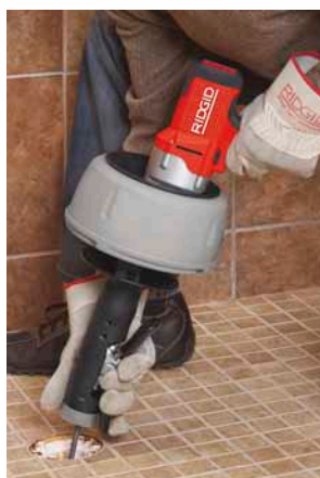
A K-45AF-5 modellben lévő \frac{3}{8} " (10 mm) kábel megnöveli a gép kapacitását 2\frac{1}{2} " (75 mm) méretű lefolyó vezeték számára
