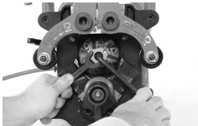
25A ábra – A vágófejek cseréje
