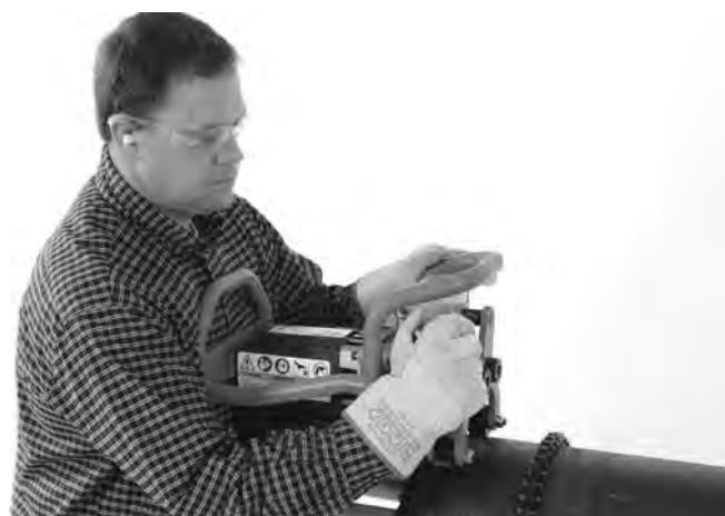
17A ábra – A befogócsavar megszorítása kézzel
