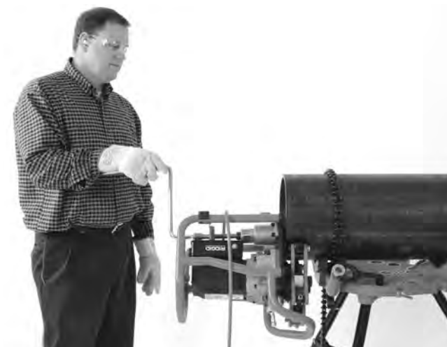
20B ábra – Leélezési művelet (Fix munkadarab/Mozgó leélezőgép)
