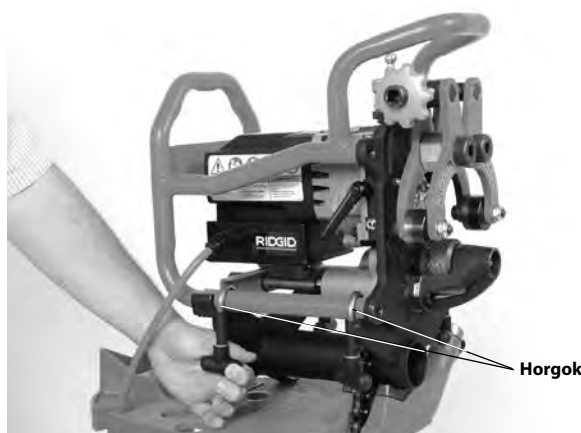
9. ábra – A leélező gép rögzítése az adapterre
