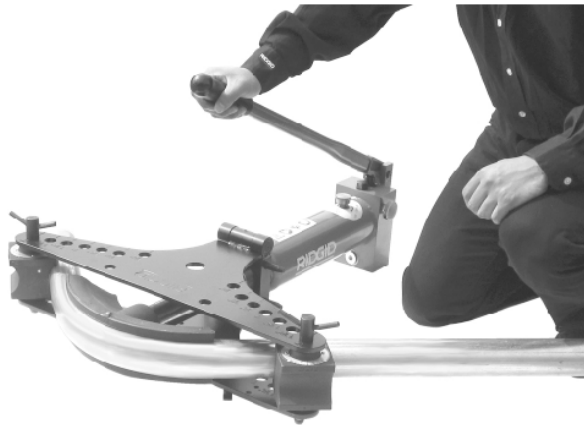
图13 - 手动液压弯管作业
