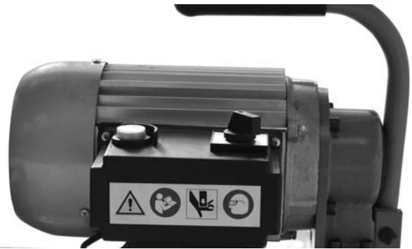
Figura 5B – Etiqueta de advertencias en la Doblatabos eléctrica
