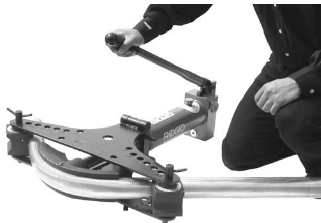
Figure 13 – Utilisation d'une cintreuse manuelle
