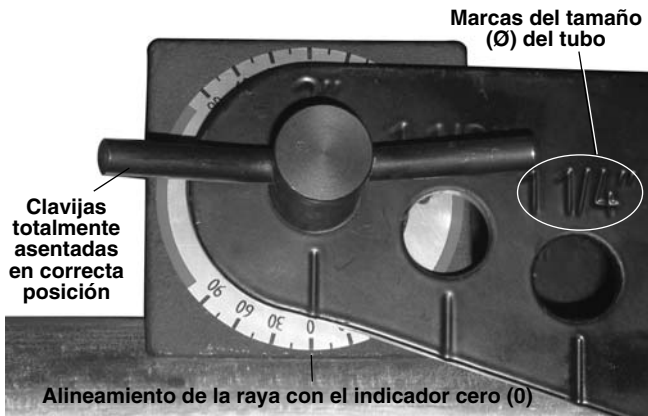
Figura 12 – Alineamiento del indicador de ángulo, principio del doblamiento
